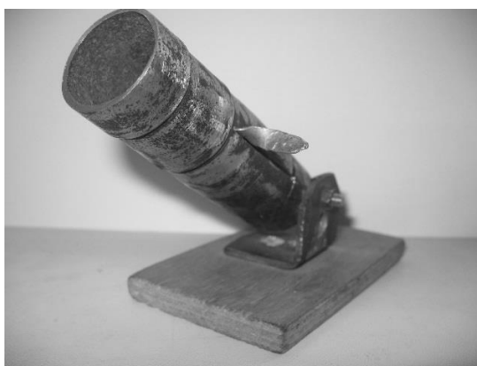
Рис. 1. Саморобна балістична гармата, зроблена вихованцем з метою відтворення польотів кульки під заданими кутами до горизонту
