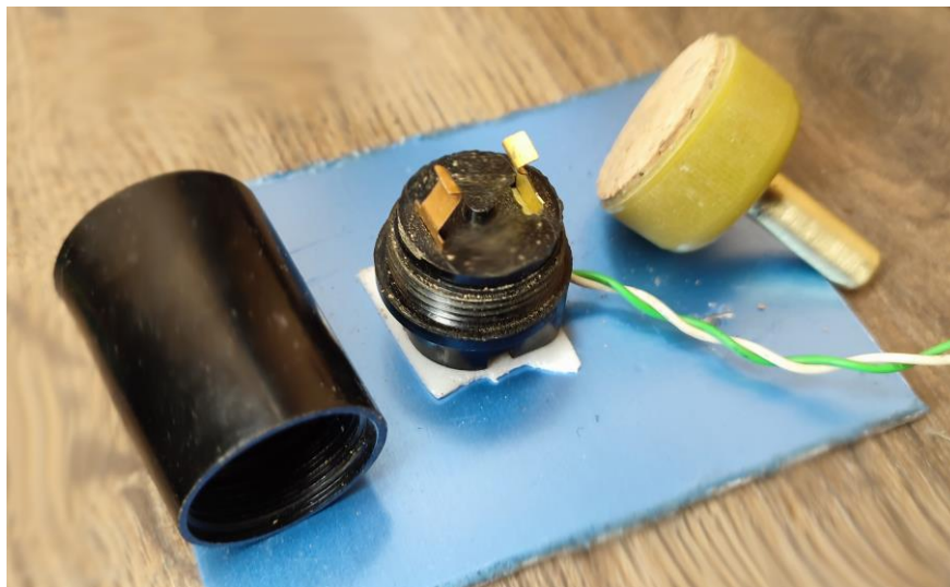
Рис. 2.6. Будова вимикача-приймача (вигляд у розібраному стані)
