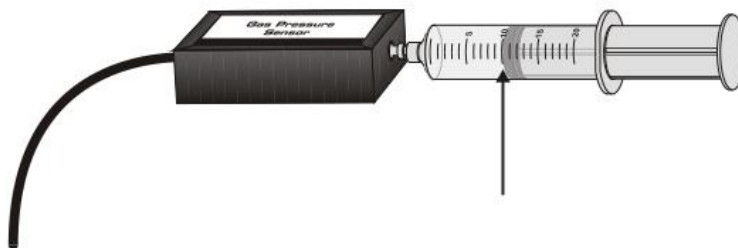
Рис. 1.10. Установка для вивчення залежності між тиском і об'ємом у газах
