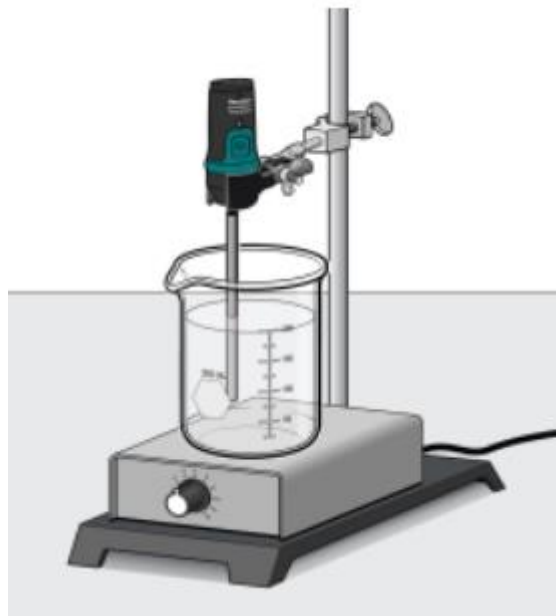
Рис. 1.16. Установка для вивчення кипіння води
