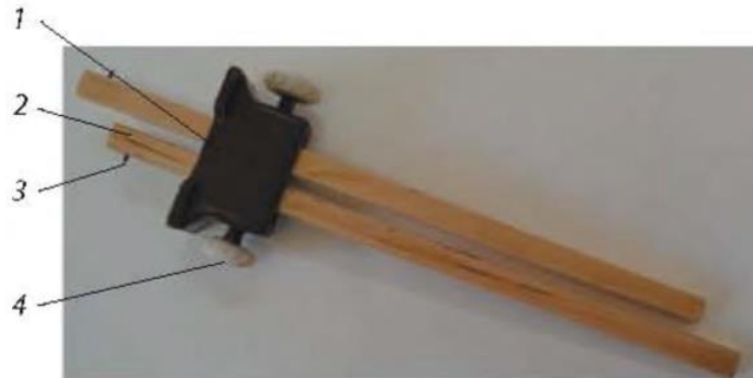
Рис. 1.2. Будова рейсмуса: 1 – колодка; 2 – бруски; 3 – шпильки; 4 – затискні гвинти (або клин)
