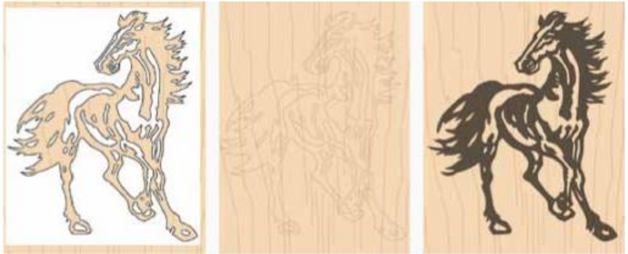
Рис. 1.9. Розмічання за трафаретом: а – трафарет, б – зображення контурів на заготовці, в – випалене зображення
