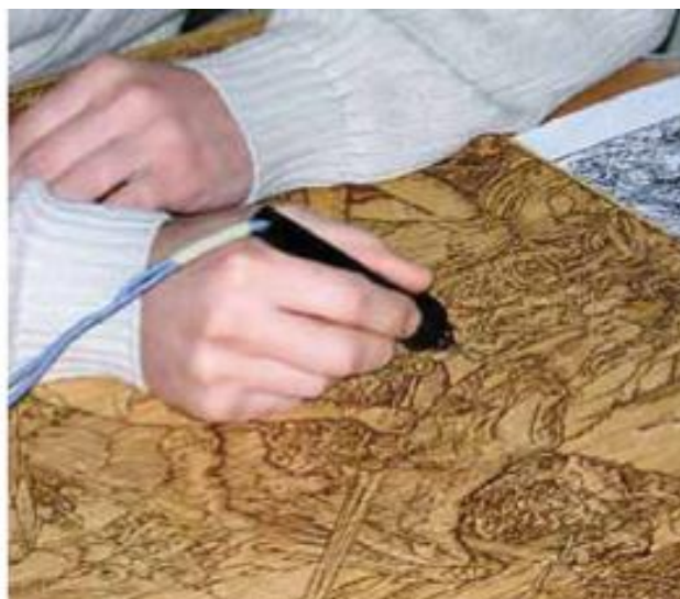
Рис. 1.11. Тримання ручки випалювача з пером.
