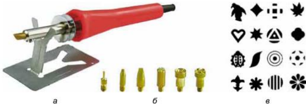
Рис. 1.5. Стрижневий випалювач: а – загальний вигляд, б – стрижневі штампів, в – елементи випалених орнаментів.
