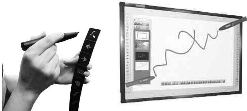
Рис. 1.29 Фото дошки з електромагнітною технологією
