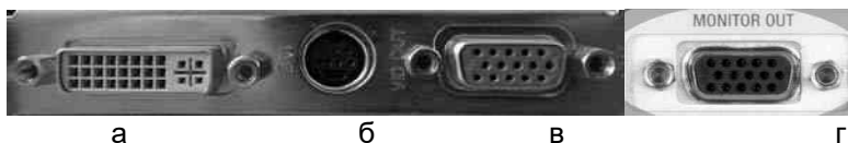
Рис. 1.40 Відео інтерфейси: а – порт DVI; б – порт S-video; в – порт VGA; г – вихід на монітор з проєктора
