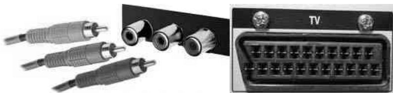
Рис. 1.44 Інтерфейс Component Video (ліворуч) та роз'єм SCART (праворуч)
