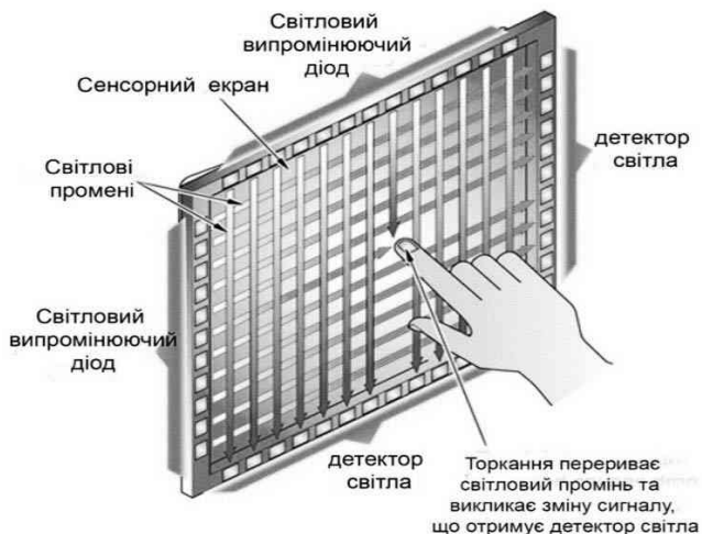
Рис. 1.28 Структура елемента дошки із сенсорно-резистивною поверхнею
