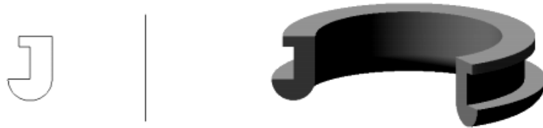
Рис. 1.69. Ескіз, вісь і елемент, утворений операцією обертання
