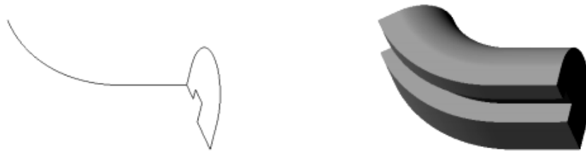
Рис. 1.70. Ескіз перетину, напрямна і елемент по траєкторії
