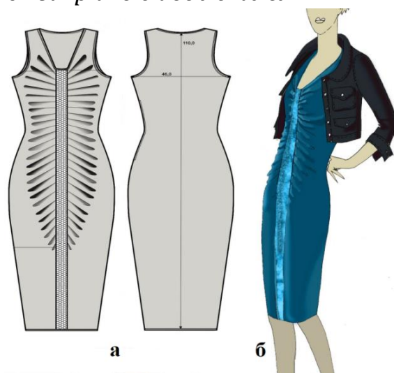
Рис. 3.49. Види ескізів швейних виробів: а) робочий, б) художній
