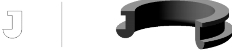
Рис. 1.69. Ескіз, вісь і елемент, утворений операцією обертання
