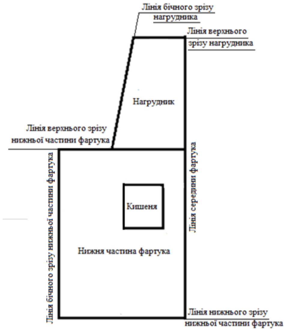
Рис. 3.50. Креслення основи фартуха з відрізним нагрудником
