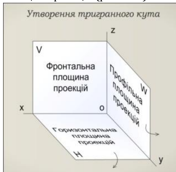
Рис. 1.42. Система площин проєкцій
