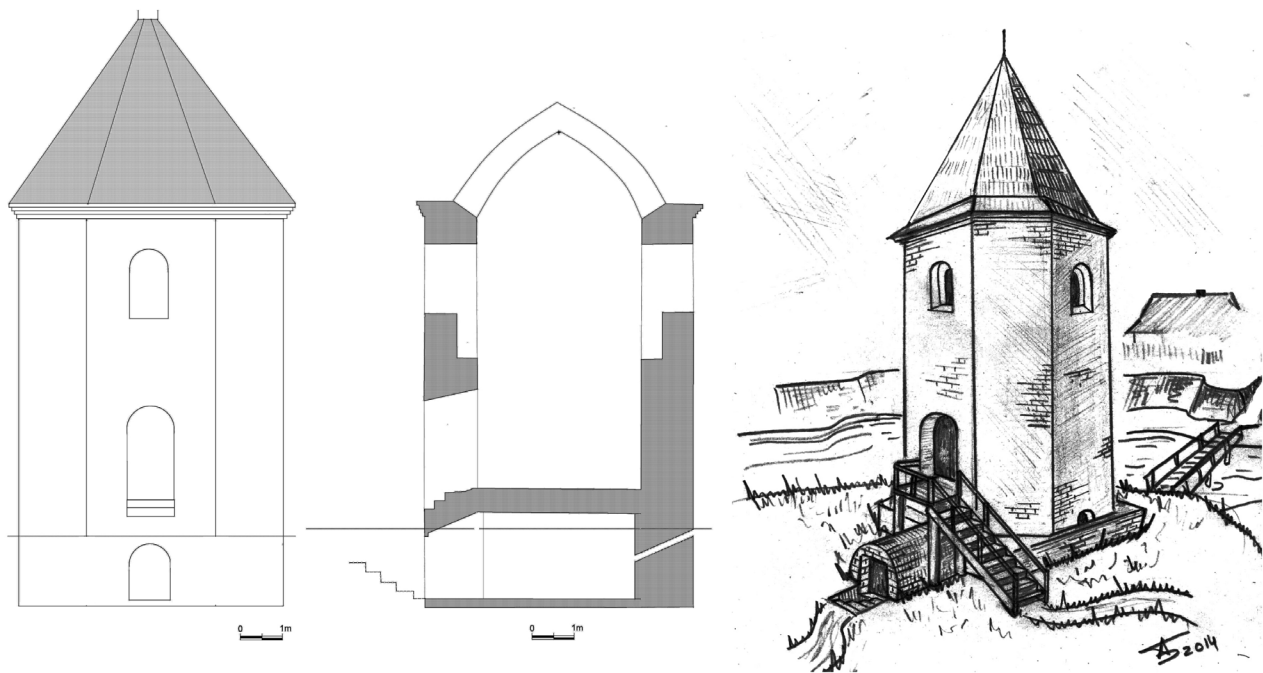
Рис. 5. Східний фасад, розріз та варіант реконструкції вежі-дзвіниці станом на кінець XVII ст. в с. Суличівка, обміри та малюнок автора
