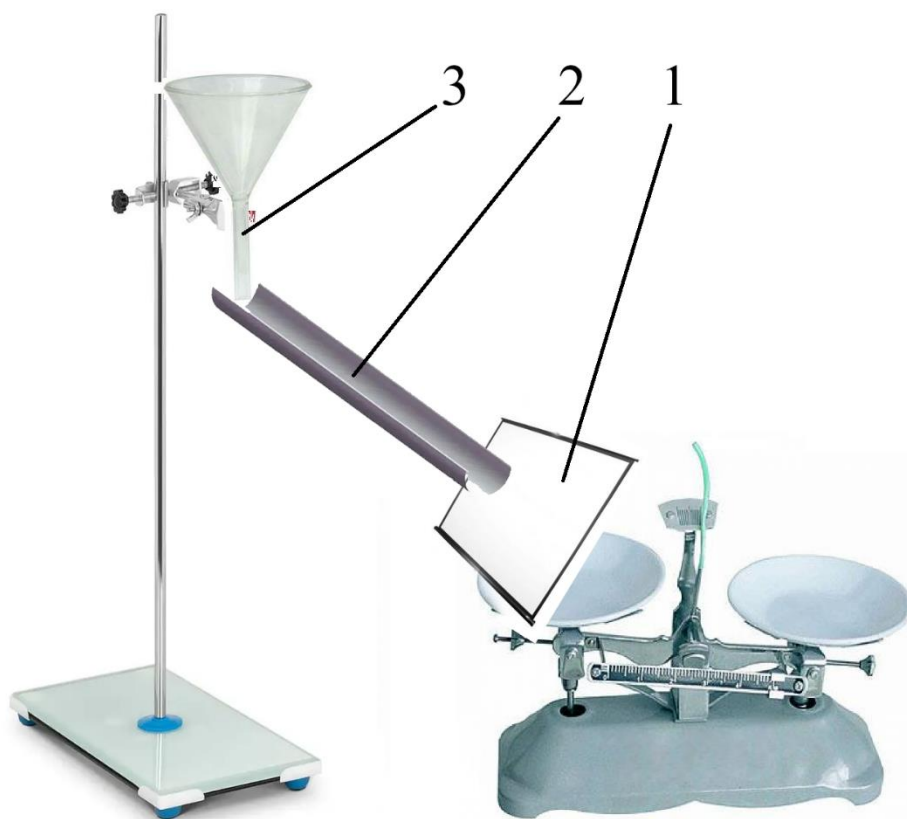
Рис. 1.1. Модель дії тиску газу
