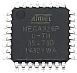
Рис. 1.4. Мікроконтролер Atmel Atmega328P-AU.
