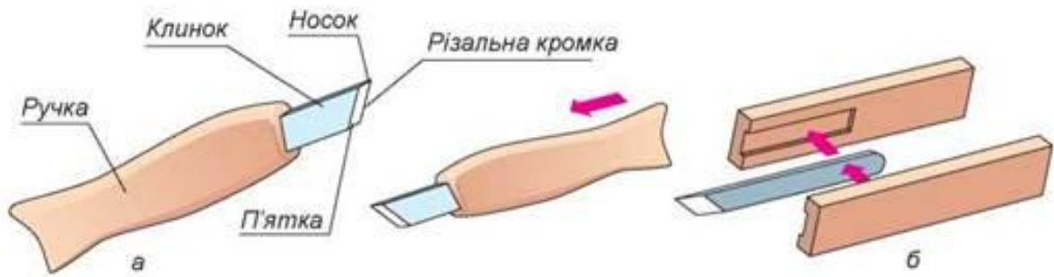
Рис. 1.5. Косий ніж: а - будова; б - виготовлення
