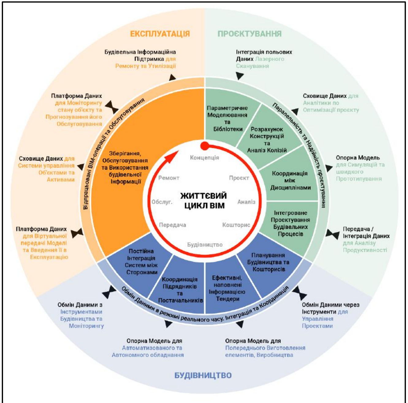
Рис.1.7. Технології ВІМ в рамках життєвого циклу будівельного об'єкту
