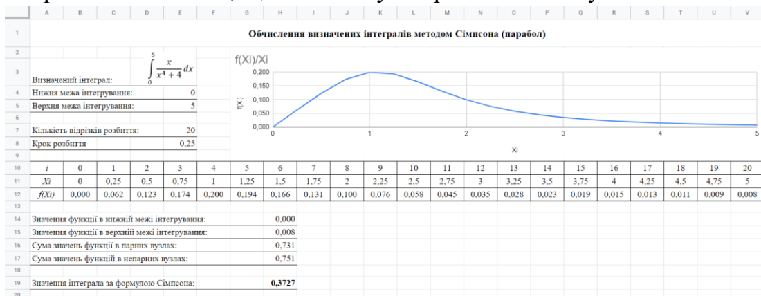
Рис. 2. Реалізація алгоритму обчислення визначених інтегралів методом Сімпсона в Google Таблицях
