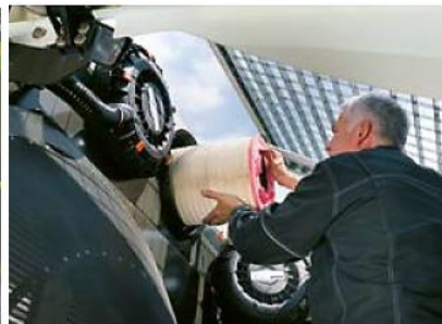
Заміна повітряного фільтра без інструментів
