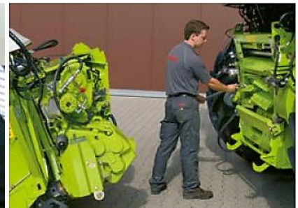
Доступ до ножового барабана
